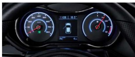
Quadro strumenti con Display digitale TFT da 3,5": per una migliore leggibilità degli avvisi di sicurezza e assistenza alla guida in tempo reale.
